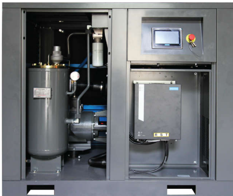
Bộ điều khiển thông minh Intelligent microcomputer control system
